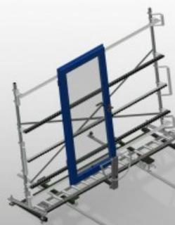
用于窗户元件运输的垂直滚道。钢制结构、坚固稳定。垂直滚轴输送架可将型材流畅地输送至下一个加工工位并且也可将成品窗户输送至存储和分类工位。让窗户元件的搬运更加简便。每个滚道单元长 3.000 mm。上下塑料滑条。三个迷你辊道输送机、带橡胶滚轮、直径 50 mm。带末端支架的基本型号。垂直滚轴输送架可借助凸缘滚轮在轨道上移动。
