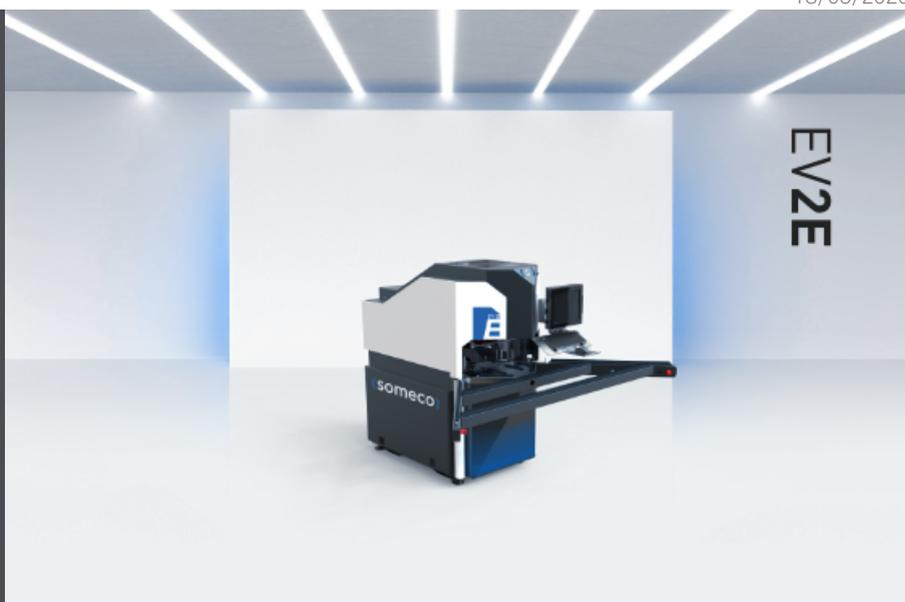
EV 2E 是一台插入式 2 轴数控清洁机、用于清洁 PVC 框架角落。刀片直径 300 毫米、利用不同的加工程序、清洁各类型材的外角。此外还配有上侧和下侧刮刀单元、用于清洁焊缝、以及上侧和下侧刮刀单元、用于清洁内角。内角和外角加工通过上侧和下侧镗孔/铣削单元完成、可清洁角落或密封垫座。利用计算机和数控可以对工作单元进行独立编程、控制型材程序和机器运行。正确配备必要工具之后、本机可以加工所有类型的标准、亚克力和涂层型材。第三个数控轴管理上侧单元机组运行、最多可以容纳 4 个工具单元。
