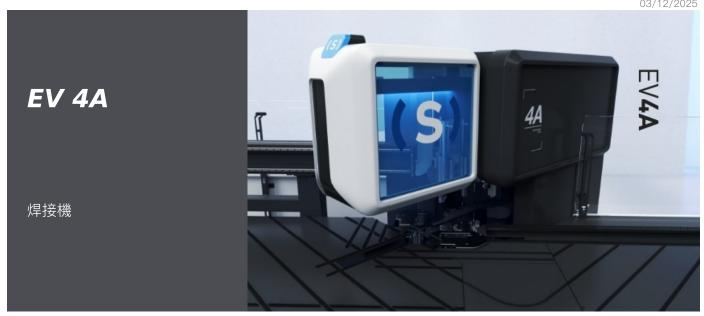
EV 4A 是 CN 清洁机、用于 PVC 框架的角度。4轴校对、全自动周期、用适当配置能够认定工件的尺寸。配有 275 mm 直径的清洁刀、通过 不同加工程序可清洁型材的外角。另外、EV 4A 还配有带刀的上组和下组来清洁焊缝。上组和下组的刀片可以清洁内侧角。内、外角的加工还 包括上/下钻孔/铣削、来清洁密封圈的槽。通过 CNC PC、可以单独控制每工位、而且可以控制设备的自动或手动运转以及工作周期。根据所 安装的不同工具、设备可以加工标准、丙烯酸、覆盖等型材。EV 4A 有三个不同型号:手动、半自动(配有旋转台)和全自动(配有旋转台和 拆卸台)。
