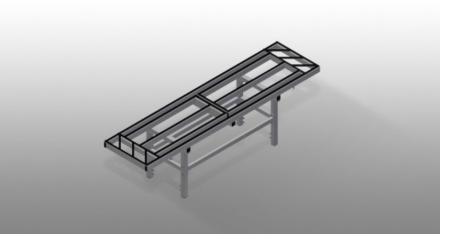
用于在特殊元件和幕墙上进行所有组装工作的组装台。钢制结构、坚固稳定。用于在特殊元件和幕墙上进行所有组装工作的组装工作台。可向两个方向拉出。该组装工作台是较大型元件组装的理想之选。由于底座采用的狭长的设计构造、因此能够从各个侧面十分轻松地触及元件。可移动组装工作台。支承面带橡胶型材。通过可大范围调节的支承面、即:将支撑面拉出并且移动工作台、能够根据加工的元件对工作台进行优化调整。用于组装生产线的机型:水平对齐的轨道确保了支承面的平整、从而能够让工作台顺利移动至支承面上;工作台可移动并且能够在轨道上十分轻松地定位;通过两个或若干工作台的组合、可对支承面进行任意的扩展;该工作台是较大型元件组装的理想之选;如果不需要该工作台、则可将其折起并推至一侧;在边缘区域、菱形排布的支架可用于纵向存放型材。
