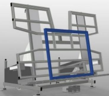
用于垂直和水平安装的组装工作台。钢制结构、坚固稳定。在从垂直输送切换至水平输送或相反时十分重要。时垂直和水平安装的理想之选。通过可无级调节的无级中间位置实现符合人体工程学原理的作业。由气动翻转。可在垂直方向上以气动方式调节高度。带塑料滑条的工作台支承面。可气动升降的滚轮支架。两个侧面、气动夹具（可降下）。四路压缩空气接口。
