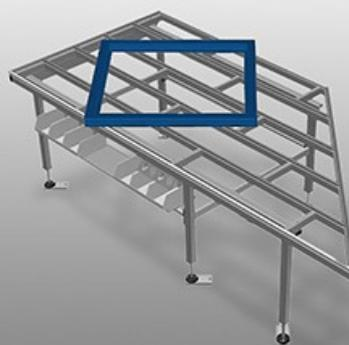
用于在框架和窗扇上进行加工作业的水平工作台。钢制结构、坚固稳定。带斜边的工作台、作为通向加工生产线或缓冲区的通道。用于在框架和窗扇上进行加工作业的组装工作台。带塑料滑条的工作台支承面。用于存放工具和配件的存放架。高度可调。模块化结构、组装简便。
