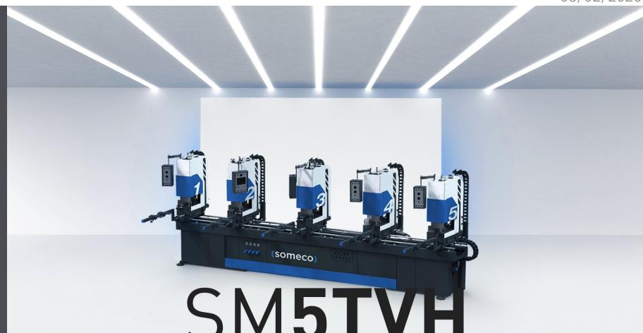
5个头在线焊接机、全自动周期、用于90°角度、从30°到180°可变角度、T型横条、H型横条和十字横条。SM 5TVH 有两个不同长度（4.440 和 5.440 mm）、另外用1个或者多头能够同时给4个框架加热。配有的加热焊缝限制器可以调节在 0,5 到 2 mm 范围内。SM 5TVH 有滑动垂直夹具。焊接深度可以调节在 2,5 或者 3 mm、另外可以调节支撑架的高度。根据需要、SM 5TVH 可以配样板（另外加的）、以加工所有的标准、亚克里和贴面型材以及大规格的型材（单件）。配有快速更换装置以便特氟隆薄膜的清洗。运转周期由 PLC 控制的、加热板由数字温度调节器（可设置 °C 或 F）。通过 LCD 显示器、可以设定加热时间和焊接时间。
