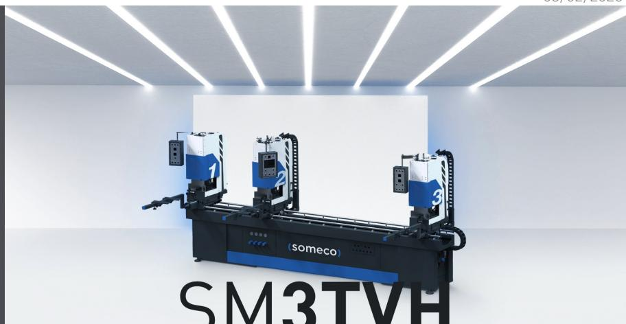
3个头在线焊接机、全自动周期、用于90°角度、从30°到180°可变角度、T型横条、H型横条和十字横条。SM 3TVH 有两个不同长度（3.440 和 4.440 mm）、另外用1个或者多头能够同时给2个框架加热。配有的加热焊缝限制器可以调节在 0,5 到 2 mm范围内。SM 3TVH 有滑动垂直夹具。焊接深度可以调节在 2,5 或者 3 mm、另外可以调节支撑架的高度。根据需要、SM 3TVH 可以配样板（另外加的）、以加工所有的标准、亚克里和贴面型材以及大规格的型材（单件）。配有快速更换装置以便特氟隆薄膜的清洗。运转周期由 PLC 控制的、加热板由数字温度调节器控制（可设置 °C 或 F）。通过 LCD 显示器、可以设定加热时间和焊接时间。
