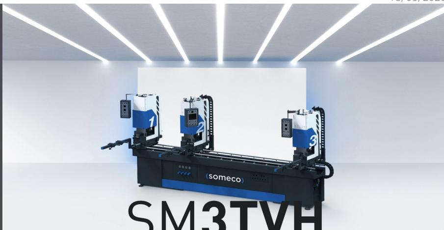
3个头在线焊接机、全自动周期、用于90°角度、从30°到180°可变角度、T型横条、H型横条和十字横条。SM 3TVH 有两个不同长度（3.440 和 4.440 mm）、另外用1个或者多头能够同时给2个框架加热。配有的加热焊缝限制器可以调节在 0,5 到 2 mm范围内。SM 3TVH 有滑动垂直夹具。焊接深度可以调节在 2,5 或者 3 mm、另外可以调节支撑架的高度。根据需要、SM 3TVH 可以配样板（另外加的）、以加工所有的标准、亚克力和贴面型材以及大规格的型材（单件）。配有快速更换装置以便特氟隆薄膜的清洗。运转周期由 PLC 控制的、加热板由数字温度调节器控制（可设置 °C 或 F）。通过 LCD 显示器、可以设定加热时间和焊接时间。
