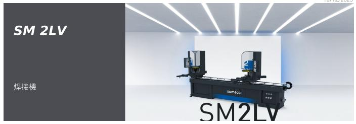
拥有自动循环功能带固定头的在线焊接机、可以实现 90°以及 30°至 180°的可变角度焊接。SM 2LV 最大可用长度为 3.440 mm、提供配备 加热切割刀和无加热切割刀两个版本。SM 2LV 配备了焊珠限位器(可以在设置过程中设定在 0.2 至 2 mm 的范围内)、还包括多个可以在直线导轨上滑动的垂直钳口。熔焊深度可以设置为 2.5 或 3 mm、支撑臂高度可调节。SM 2LV 可以配备反凸模具(选配)来完成标准焊接和无缝焊接、并能够加工所有类型的标准、丙烯酸以及涂层型材。这款焊接机可以配置快速更换系统、与 SM 4H 四头焊接机共用反凸模具。此外、还与获得专利的无缝反凸模具相兼容、通过几步简单的型材准备步骤即可在框架表面完成无缝焊接。这种焊接方法大大缩短并简化了后续加工周期、对生产率和成品质量都有重大提升。可以轻松清洁特氟龙涂层薄膜。可以通过 PLC 控制工作周期、通过数字温度控制器控制加热板(可以设置为摄氏度或华氏度)、LCD 显示屏允许设置加热时间。
