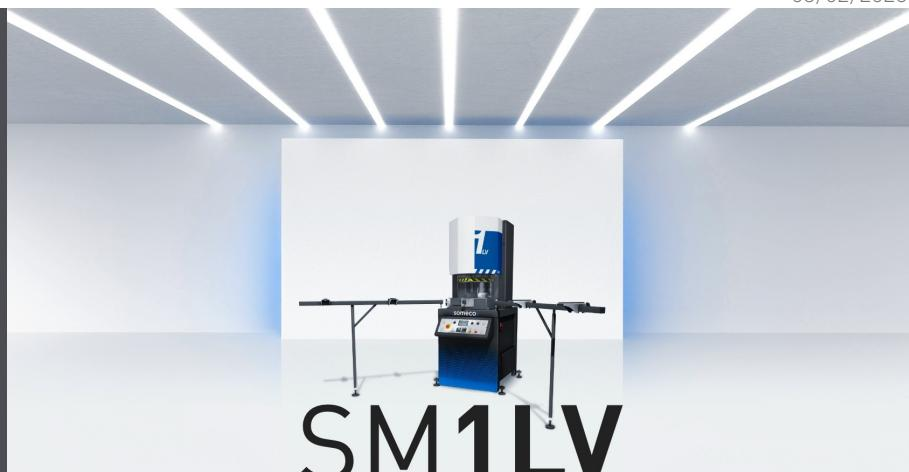
拥有自动循环功能的单头焊接机、可以实现 90° 以及 30° 至 180° 的可变角度焊接、带有下降式加热板。SM 1LV 配备了加热焊珠限位器（可以在设置过程中设定在 0.2 至 2 mm 的范围内）、还包括多个可以在直线导轨上滑动的垂直钳口。熔焊深度可以设置为 2.5 或 3 mm、支撑臂高度可调节。SM 1LV 可以配备反凸模具（选配）、并能够加工所有类型的标准、丙烯酸以及涂层型材。这款焊接机可以配置快速更换系统、与 SM 4H 四头焊接机共用反凸模具。可以轻松清洁特氟龙涂层薄膜。可以通过 PLC 控制工作周期、通过数字温度控制器控制加热板（可以设置为摄氏度或华氏度）、LCD 显示屏允许设置加热时间和焊接时间。
