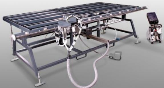
用于塑料窗扇五金件安装的窗扇组装台。在最短时间内以符合人体工程学的方式上紧五金件。五金配件组装台用于对五金件进行测量和裁切。通过多种工序来优化窗框加工。组装工作台可气动倾斜。窗扇测量和定心装置可以气动方式移动。带有用于中间锁点和固定锁点止动器的五金件冲压机。两个用于不同窗扇宽度的止动器。可移动且由气动调节高度的螺钉紧固装置。螺钉输送装置。带塑料滑条的工作台支承面。
