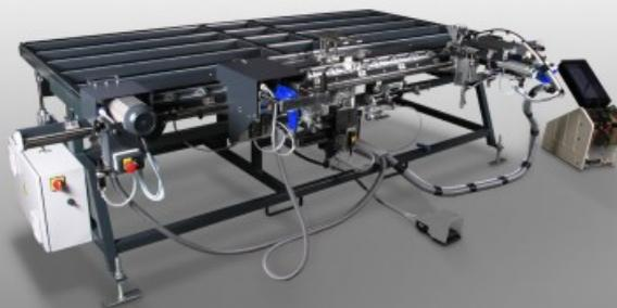
用于塑料和铝合金窗扇五金件安装的窗扇组装台。在最短时间内以符合人体工程学的方式上紧五金件。五金配件组装台用于对五金件进行测量和裁切。通过多种工序来优化窗框加工。组装工作台可气动倾斜。窗扇测量和定心装置可以气动方式移动。带有用于中间锁点和固定锁点止动器的五金件冲压机。两个用于不同窗扇宽度的止动器。可移动且由气动调节高度的螺钉紧固装置。用于第二种长度的螺丝钉的手动送料斗。自动紧固深度控制。螺钉输送装置。带塑料滑条的工作台支承面。
