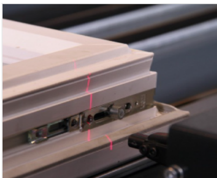
激光单元 (选修的) 用于螺栓位置的激光
