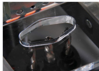
执手孔钻孔装置 FAZ 2800 (选修的) 固定式执手孔钻孔装置集成有液压气动进给和夹紧装置并且配备三轴钻头
