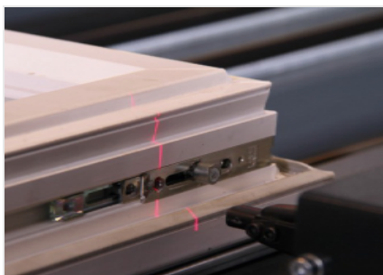
激光单元 (选修的) 用于螺栓位置的激光
