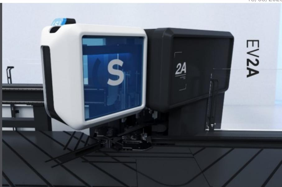
EV 2A 是 CN 清洁机、用于 PVC 框架的角度。2轴校对、全自动周期、用适当配置能够认定工件的尺寸。配有 275 mm 直径的清洁刀、通过不同加工程序可清洁型材的外角。另外、EV 2A 还配有带刀的上组和下组来清洁焊缝。上组和下组的刀片可以清洁内侧角。内、外角的加工还包括上/下钻孔/铣削、来清洁密封圈的槽。通过 CNC PC、可以单独控制每工位、而且可以控制设备的自动或手动运转以及工作周期。根据所安装的不同工具、设备可以加工标准、丙烯酸、覆盖等型材。EV 2A 有三个不同型号：手动、半自动（配有旋转台）和全自动（配有旋转台和拆卸台）。
