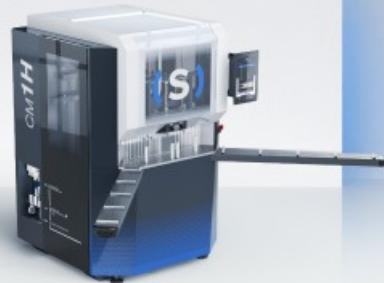
专用于加工 45°预切割 PVC 型材轮廓的铣床。本机床所集成的门窗生产流程当中包括使用无缝技术反凸模具的 Someco SM 系列机床、负责对型材进行轮廓加工、为随后的无缝焊接阶段做准备。CM 1H 具有三个电主轴、一个用于端面铣刀、另外两个可以搭配不同的工具、即使是不同材料的型材、也能有效地进行轮廓加工。可以在机床上进行编程、可以导入并执行预定义的优化加工清单。
