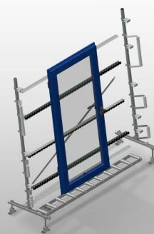
Rulliera verticale per il trasporto e l'immagazzinaggio di elementi di finestra. Solida struttura in acciaio. Espansione in un sistema modulare. Rulliera verticale per il trasporto continuo e l'immagazzinaggio di elementi di finestra. Facilità di manovrare gli elementi di finestra. Ogni unità di rulliera è lunga 2.000 mm. Listelli scorrevoli in PVC superiori e inferiori. Tre guide a rotelle con rulli in gomma, diametro 50 mm. Unità di base senza montante terminale.
