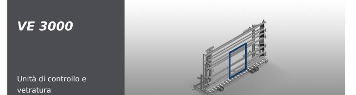
Unità di controllo e vetratura per la vetratura e il controllo finale nella produzione singola e di serie di ante. Montaggio rapido ed esatto di finestre, porte ed elementi. Precisione grazie alla pressatura parallela delle barre di serraggio. Solida struttura in acciaio. Altezza regolabile in continuo. Facile da manovrare tramite pedale. Due barre di serraggio ribaltabili e spostabili pneumaticamente e attacco dell'aria compressa quadruplo.
