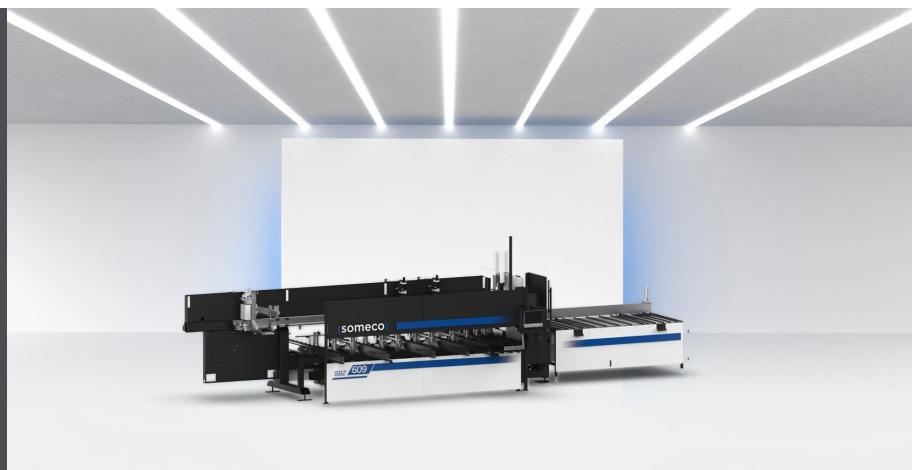
Centro di lavoro per avvitare rinforzo, forare e fresare profili pretagliati per la costruzione di finestre e porte con e senza armatura in acciaio. Realizzato in versione portale per grosse sezioni di profili e per processi ottimizzati. Aumento dell'efficienza grazie alla lavorazione parallela dell'avvitatore per rinforzi esterno.
