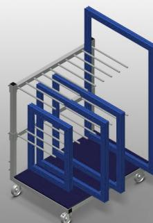
Carrello per il trasporto interno di telai e ante. Solida struttura in acciaio. Carrello con rastrelliera per il trasporto e l'immagazzinaggio di telai e ante. Supporto in legno duro. Separatori per nove telai. Separatori regolabili in altezza. Quattro ruote orientabili, due delle quali con freno fisso.
