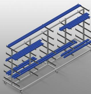
Carrello per l'immagazzinaggio orizzontale e il trasporto di profili. Solida struttura in acciaio. Trasporto dei profili orizzontale. Trasporto facile per il materiale delle barre e i ritagli di profili. Bracci di supporto rivestiti in gomma. Carrello con ripiani per profili sui due lati. Sei ripiani per montante. Tre montanti centrali. Sei ruote orientabili, due delle quali con freno fisso.
