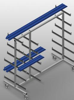
Carrello per l'immagazzinaggio orizzontale e il trasporto di profili. Solida struttura in acciaio. Trasporto dei profili orizzontale. Bracci di supporto rivestiti in gomma. Carrello con ripiani per profili sui due lati. Sei ripiani per montante. Un montante centrale. Quattro ruote orientabili, due delle quali con freno fisso.
