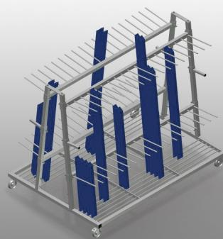
Carrello per l'immagazzinaggio verticale e il trasporto di profili. Solida struttura in acciaio. Trasporto dei profili verticale. Su due lati rispetto al carrello da caricare. 18 scomparti per lato. Facili operazioni di carico e scarico. Sufficiente per 120-160 barre di profili. Separatori regolabili in altezza. Superficie d'appoggio in forma di rastrelliera per barre. Quattro ruote orientabili, due delle quali con freno fisso.
