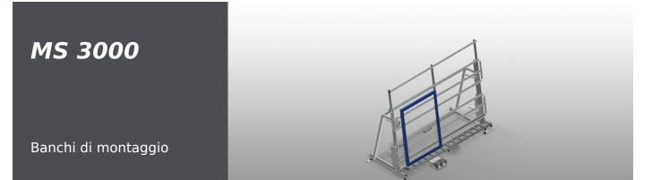
Banco di montaggio per il montaggio verticale. Solida struttura in acciaio. Ideale per il montaggio verticale. Adatto a linee. Posizioni intermedie regolabili in continuo per l'ergonomia del lavoro. Regolazione dell'altezza con cilindro pneumatico. Supporto a rulli con rulli in acciaio. Supporto del tavolo con listelli scorrevoli in PVC. Due serraprofili spostabili in orizzontale. Attacco dell'aria compressa quadruplo.
