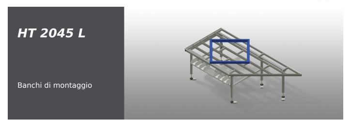
Banco orizzontale per tutti i lavori su telai e ante. Solida struttura in acciaio. Banco di lavoro con piano inclinato, viene utilizzato come passaggio nella linea di produzione o come zona di appoggio temporaneo. Banco di montaggio per tutti i lavori su telai e ante. Supporto del tavolo con listelli scorrevoli in PVC. Piano di appoggio per utensili e accessori. Regolabile in altezza. Facilità di montaggio in un sistema modulare.
