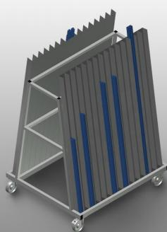
Carrello per fermavetri per il trasporto e la classificazione di fermavetri. Solida struttura in acciaio. Ideale per il trasporto verticale e la classificazione di fermavetri. Carrello per fermavetri con 30 scomparti. 15 scomparti per lato. Ripiano inferiore rivestito in gomma. Quattro ruote orientabili, due delle quali con freno fisso.
