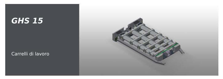
Facile spostamento dei vetri in combinazione con il carrello portavetro GFW 15. Con dispositivo di sollevamento pneumatico, comandabile tramite valvola a pedale, sollevamento massimo = 50 mm. Rulliere inferiori dotate di un totale di  $15 \times 4$  rulli in PVC. Completo di guida di inserimento per il carrello portavetro GFW 15. Dimensioni della base:  $2.100 \times 1.250$  mm.
