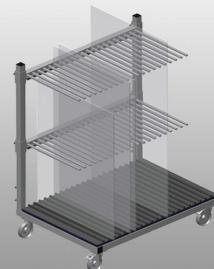
Carrello portavetro con rastrelliera classificatrice. Solida struttura in acciaio. Ideale per classificare i vetri. Supporto in legno duro con feltro. Separatori per 20 lastre di vetro. Separatori regolabili in altezza. Quattro ruote orientabili, due delle quali con freno fisso.
