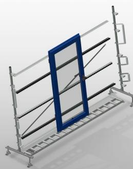
Rulliera verticale per il trasporto e l'immagazzinaggio di elementi di finestra. Solida struttura in acciaio. Espansione in un sistema modulare. Rulliera verticale per il trasporto continuo e l'immagazzinaggio di elementi di finestra. Facilità di manovrare gli elementi di finestra. Ogni unità di rulliera è lunga 4.000 mm. Listelli scorrevoli in PVC superiori e inferiori. Tre guide a rotelle con rulli in gomma, diametro 50 mm. Unità di base senza montante terminale.
