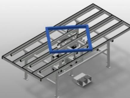
Table de levage pivotante pour le montage et la mise en place du joint. Construction en acier stable. Idéal pour le montage et la mise en place du joint. Réglable en hauteur. Table intérieure pneumatique réglable en hauteur. Table intérieure pivotante à frein de blocage pneumatique. Table intérieure à barres en caoutchouc. Table extérieure à glissières PVC. Raccord d'air comprimé quadruple.
