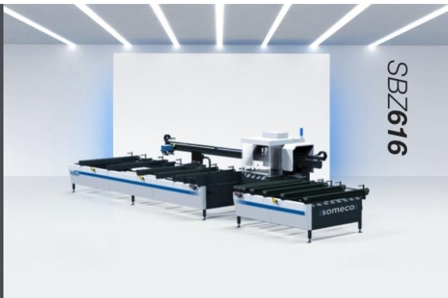
Das Allround-Talent im Einsatz als schneller Sägeautomat. Maximale Bearbeitungsgeschwindigkeit bei höchstem Qualitätsniveau durch ein Achsengesteuertes Sägeaggregate. Sägeautomat mit programmierbaren Sägeaggregaten, für den Zuschnitt von Profilen für den Fenster-, Türen- und Fassadenbau.
