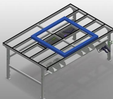
Montagetisch für alle Arbeiten an Rahmen und Flügeln. Stabile Stahlkonstruktion. Montagetisch für alle Arbeiten an Rahmen und Flügeln. Horizontaler Rahmentransport. Ablageboden zum Ablegen von Werkzeug und Zubehör. In der Höhe justierbar. Tischauflage mit Kunststoff-Gleitleisten. Einfache Montage im Baukastensystem.
