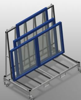
Kommissionswagen für innerbetrieblichen- und LKW-Transport der Fensterelemente. Stabile Stahlkonstruktion. Wagen für inner- und außerbetrieblichen Transport. Aufnahme für Staplertransport. Vier Haken für Krantransport. Vier Zurrgrurthalter. Profilaufage mit Gummibelag. Lenkrollen abnehmbar, dadurch sicherer Stand des Kommissionswagens auf dem LKW. Vier Lenkrollen, davon zwei mit Feststellbremse.
