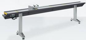
Profilauflage und Längenanschlag, verfahrbar über Handrad mit Ablesung über Digitaldisplay. Positioniergenauigkeit  $\pm 0,5$  mm.
