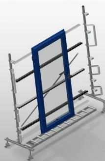
Convoyeur à rouleaux vertical pour le transport et le stockage des éléments de fenêtre. Construction en acier stable. Extension dans le système modulaire. Convoyeur à rouleaux vertical pour le transport et le stockage continu des éléments de fenêtre. Manipulation simple des éléments de fenêtre. Chaque unité de convoyeur à rouleaux 2.000 mm de long. Glissières PVC haut et bas. Trois convoyeurs à roulettes caoutchouc, diamètre 50 mm. Unité de base sans support d'extrémité.
