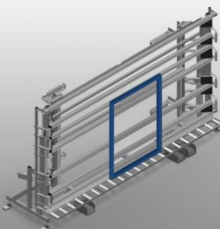
Unité de contrôle et de vitrage pour le vitrage et le contrôle final dans la fabrication individuelle et de série. Montage rapide et précis des fenêtres, portes et éléments. Précision grâce au serrage parallèle des barres. Construction en acier stable. Réglage progressif de la hauteur. Manipulation simple par interrupteur à pédale. 2 barres de serrage pneumatiques rabattables et déplaçables et raccord d'air comprimé quadruple.
