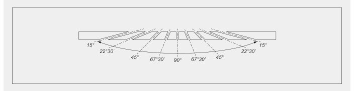
Réglage mécanique des angles intermédiaires
