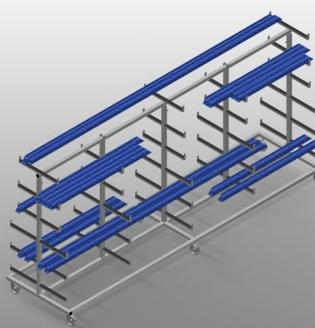
Chariot de profilé pour le stockage et le transport horizontaux des profilés. Construction en acier stable. Transport de profilé horizontal. Transport aisément des barres et des découpes de profilés. Bras supports recouverts de caoutchouc. Chariot de profilés à support de profilés sur deux côtés. 6 rangements par support. 3 supports médians. 6 roulettes de direction, dont 2 à frein de blocage.
