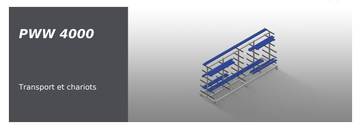
Chariot de profilé pour le stockage et le transport horizontaux des profilés. Construction en acier stable. Transport de profilé horizontal. Transport aisé des barres et des découpes de profilés. Bras supports recouverts de caoutchouc. Chariot de profilés à support de profilés sur deux côtés. 6 rangements par support. 3 supports médians. 6 roulettes de direction, dont 2 à frein de blocage.
