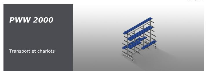
Chariot de profilé pour le stockage et le transport horizontaux des profilés. Construction en acier stable. Transport de profilé horizontal. Bras supports recouverts de caoutchouc. Chariot de profilés à support de profilés sur deux côtés. 6 rangements par support. 2 supports médians. 4 roulettes de direction, dont 2 à frein de blocage.
