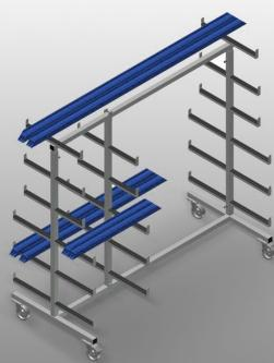
Chariot de profilé pour le stockage et le transport horizontaux des profilés. Construction en acier stable. Transport de profilé horizontal. Bras supports recouverts de caoutchouc. Chariot de profilés à support de profilés sur deux côtés. 6 rangements par support. 1 support médian. 4 roulettes de direction, dont 2 à frein de blocage.
