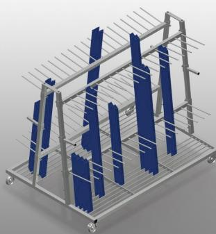
Chariot de profilé pour le stockage et le transport verticaux des profilés. Construction en acier stable. Transport de profilé vertical. Chariot de profilés à chargement sur deux côtés. 18 compartiments par face. Chargement et déchargement simples. Capacité de 120 - 160 barres de profilés. Séparateurs réglables en hauteur. Surface d'installation sous forme de fond en grille de barres. 4 roulettes de direction, dont 2 à frein de blocage.
