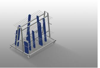
Chariot de profilé pour le stockage et le transport verticaux des profilés. Construction en acier stable. Transport de profilé vertical. Chariot de profilés à chargement sur deux côtés. 18 compartiments par face. Chargement et déchargement simples. Capacité de 120 - 160 barres de profilés. Séparateurs réglables en hauteur. Surface d'installation sous forme de fond en grille de barres. 4 roulettes de direction, dont 2 à frein de blocage.
