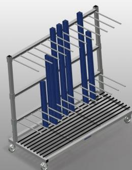
Chariot de profilés pour le stockage et le transport verticaux des profilés en aluminium. Construction en acier stable. Idéal pour le transport et l'entreposage compact des découpes de profilés. Transport de profilé vertical. Suffisant pour 12 - 60 Profilés. Séparateurs réglables en hauteur. Support inférieur avec barres en caoutchouc. Séparateurs avec un tuyau de protection. Installation en marche arrière avec barres caoutchouc. 4 roulettes de direction, dont 2 à frein de blocage.
