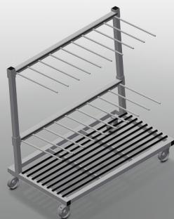
Chariot de profilés pour le stockage et le transport verticaux des profilés en aluminium. Construction en acier stable. Idéal pour le transport et l'entreposage compact des découpes de profilés. Transport de profilé vertical. Suffisant pour 30 - 40 Profilés. Séparateurs réglables en hauteur. Support inférieur avec barres en caoutchouc. Séparateurs avec un tuyau de protection. Installation en marche arrière avec barres caoutchouc. 4 roulettes de direction, dont 2 à frein de blocage.
