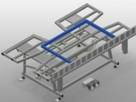
Table d'assemblage pour le montage vertical et horizontal. Construction en acier stable. Important lors du passage du transport vertical vers le transport horizontal et inversement. Idéal pour montage vertical et horizontal. Basculement pneumatique. Support de table à glissières PVC. Support à rouleaux à abaissement pneumatique. Raccord d'air comprimé quadruple.
