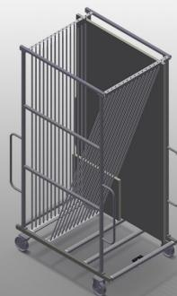
Construction en acier stable. Idéal pour le tri du verre. Pour le transport de vitrages à l'intérieur de l'entreprise. Séparateur pour 15 vitres. Accès possible de deux côtés. La surface de contact est recouverte de profil caoutchouc. Séparateur avec protection plastique. Etrier de transport sur deux faces pour le déplacement. Deux roulettes de direction et deux roues fixes.
