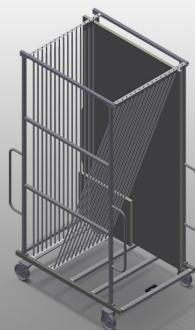
Construction en acier stable. Idéal pour le tri du verre. Pour le transport de vitrages à l'intérieur de l'entreprise. Séparateur pour 15 vitres. Accès possible de deux côtés. La surface de contact est recouverte de profil caoutchouc. Séparateur avec protection plastique. Etrier de transport sur deux faces pour le déplacement. Deux roulettes de direction et deux roues fixes.
