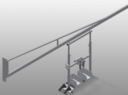
Support d'appareils à air comprimé et électrique. Fixation sur le mur ou la colonne en acier. Dispositif de rangement mobile pour outils et appareils à air comprimé, permettant d'améliorer les conditions de travail. Aucun tuyau sur le sol. Porte-outils à réglage en hauteur. De série avec deux tuyaux en spirale (sans outils). Avec unité de maintenance et tuyau de raccord d'air. Prises de sécurité doubles. Raccord d'air comprimé quadruple.
