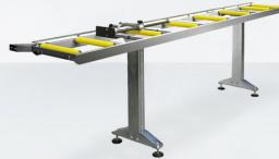
Structure tubulaire en acier munie de pieds réglables et de rouleaux en acier recouverts de PVC: équipée de rouleaux de 240 mm, la longueur du chemin d'évacuation atteint 3.500 mm.
