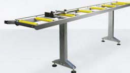
Structure tubulaire en acier munie de pieds réglables et de rouleaux en acier recouverts de PVC: équipée de rouleaux de 240 mm, la longueur du chemin d'évacuation atteint 3.500 mm.
