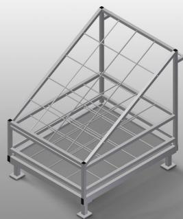
Étagère de mise à disposition avec triage des renforts métalliques. Construction en acier stable. Stockage vertical des profilés en acier. Dimensions extérieures réduites. Disposition claire du profilé pour les longueurs fixes. Transportable avec un chariot élévateur.
