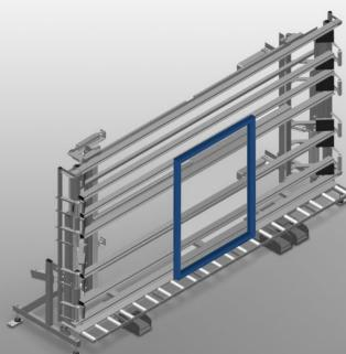
Unidad de control y de acristalamiento para acristalar y hacer el control final en la fabricación individual y en serie. Montaje rápido y exacto de ventanas, puertas y elementos. Exactitud gracias al prensado paralelo de traviesa. Estable construcción en acero. Ajuste continuo de la altura. Fácil manipulación por comutador de pedal. Dos traviesas de prensa neumáticamente abatibles y móviles y cuádruple toma de aire comprimido.
