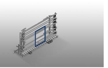
Unidad de control y de acristalamiento para acristalar y hacer el control final en la fabricación individual y en serie. Montaje rápido y exacto de ventanas, puertas y elementos. Exactitud gracias al prensado paralelo de traviesa. Estable construcción en acero. Ajuste continuo de la altura. Fácil manipulación por conmutador de pedal. Dos traviesas de prensa neumáticamente abatibles y móviles y cuádruple toma de aire comprimido.
