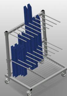
Carro de perfiles para el almacenamiento y transporte vertical de perfiles. Construcción estable de acero. Transporte vertical de perfiles. Carro de perfiles con carga en un lado. Fácil carga y descarga. Suficiente para 30-40 barras de perfil. La altura del compartimento es ajustable. Superficie de apoyo con suelo de rejilla para barras. Cuatro ruedas, dos de ellas con freno de fijación.
