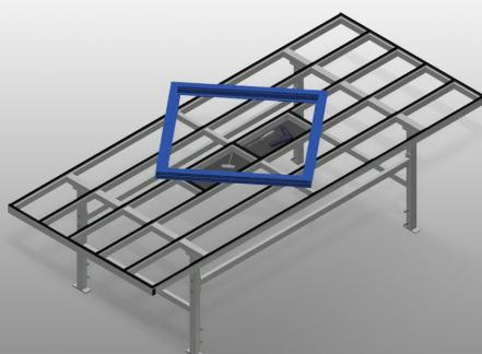
Mesa de montaje ampliable para todos los trabajos en marcos y hojas. Construcción estable de acero. Mesa de montaje para todos los trabajos en marcos y hojas. Transporte horizontal del marco. Bandeja de almacenamiento para la colocación de herramientas y accesorios. Altura regulable. Superficie de apoyo de la mesa con barras deslizantes de plástico. Instalación sencilla con un diseño de sistema modular.
